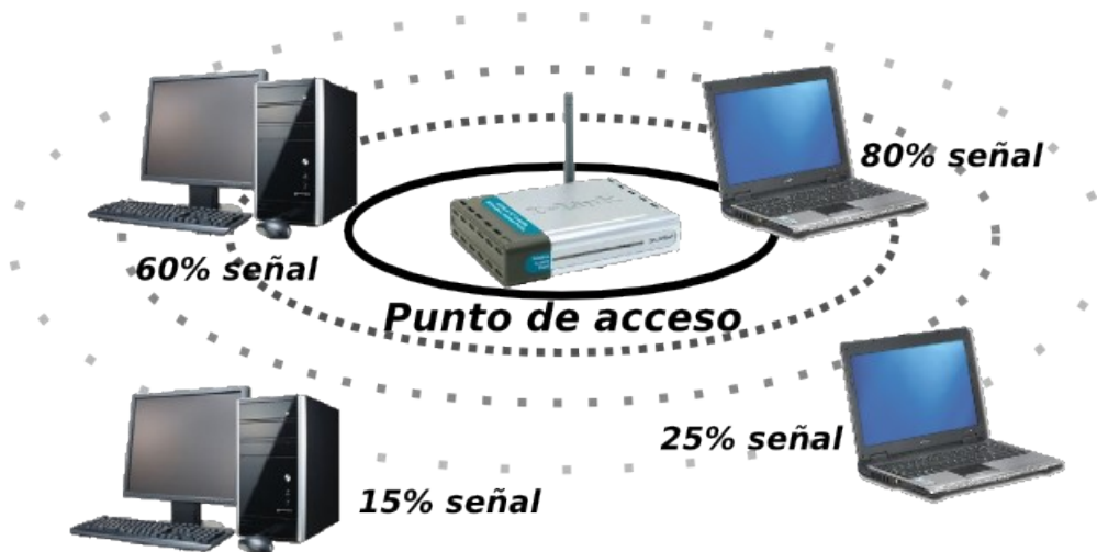
Ilustración 3: Red inalámbrica o wifi simple
